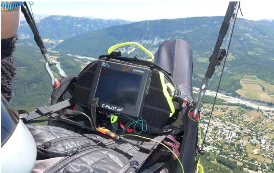
Верхняя часть кокпита снимается вместе с инструментами, так что Вы можете взять её прямо на брифинг. Также она имеет встроенный карман для USB-батареи (аккумулятора).
