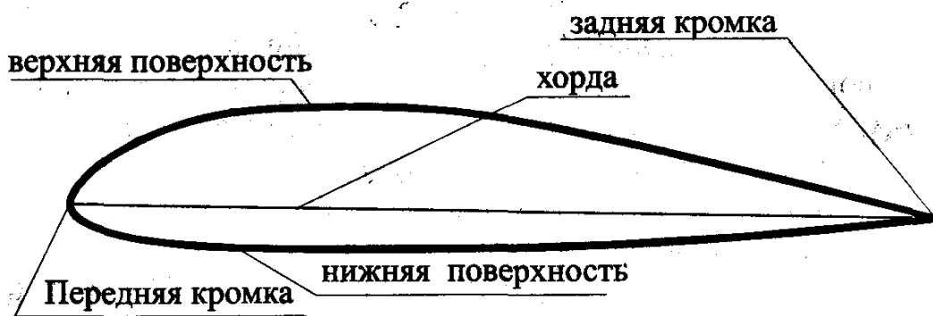
Рис.14. Геометрические характеристики крыла
