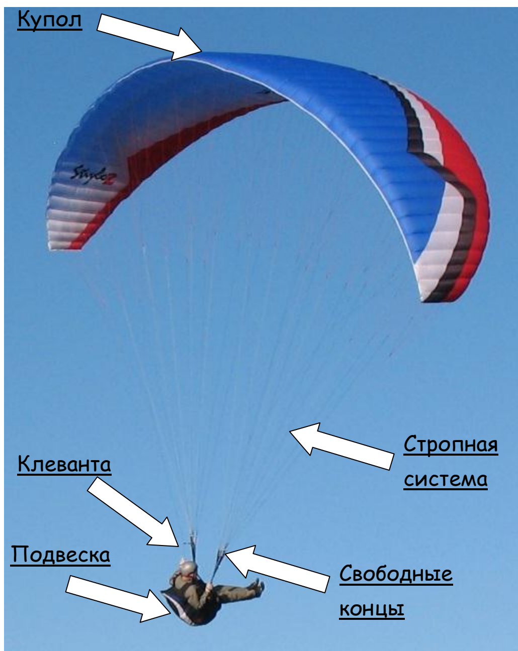
Рис.6. Составные части парашюта как летательного аппарата
